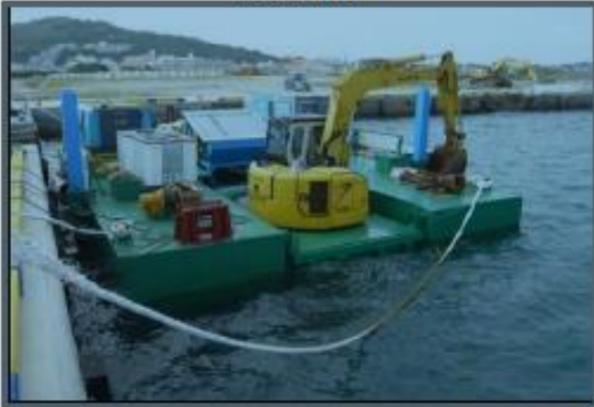
多目的低床切込潜水作業台船
