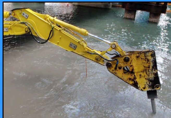
パッカー・ビッグー コンクリート油圧破碎工 最大 1.68MN
