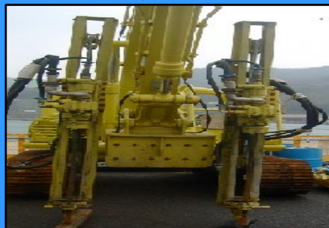
ドリフター ケミカルアンカー等穿孔及び削孔工 (コアドリル) 径 φ30~150mm
