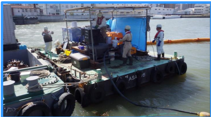
二連結小型グラウンドポンプ作業船 ASA-106(サンドポンプ搭載船)
