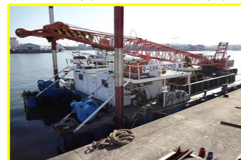
弁財天一号(50t吊クローラー台船)
