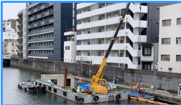
二連結小型グラウンドポンプ作業船 ASA-106(サンドポンプ搭載船)
