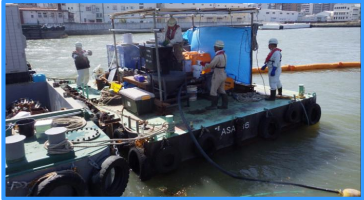
二連結小型グランドポンプ作業船 ASA-106(サンドポンプ搭載船)
